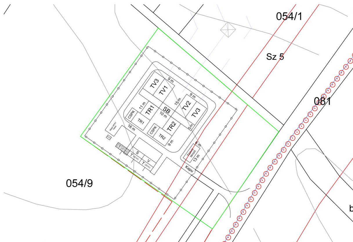
A tervezett 132/22 kV-os elektromos alállomás rajza
