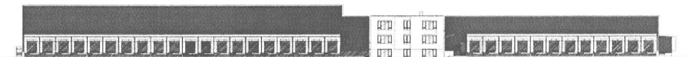
A komplexum oldalnézeti látványrajza. Középen az irodaház, oldalt a raktárcsarnokok a dokkoló kapukkal.
